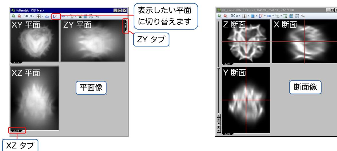
スライス表示 (39ページ参照) の状態でXZ・ZY平面を表示すると、スライス表示 (Z断面像) に加えてX断面像 ("ZY" タブ) とY断面像 ("XY" タブ) が表示され、現在表示中の断面の位置が赤い線で表示されます (上図右)。赤い線を直接ドラッグして表示断面を移動することもできます。
